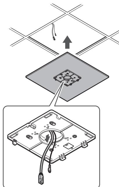
8 將固定用五金C調整到天花板框架的高度，並鎖緊螺絲 ( M4 × 10mm ) 連接。
