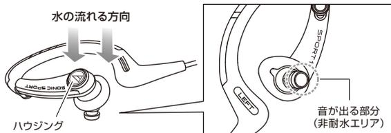
本体はIPX5相当の防水処理を行なっていますが、「音が出る部分」は非耐水エリアで、完全防水ではありません。故意に水中に沈めたり、水中では使用しないでください。また、水洗いの後は、乾いた布で水分を拭き取ってください。「音が出る部分」に水気が残ると、音が出ない場合があります。その場合は、右図のように乾いた布を当てて、20回程度振り、水気を完全に除去してください。ドライヤーなどで乾かさないでください。
