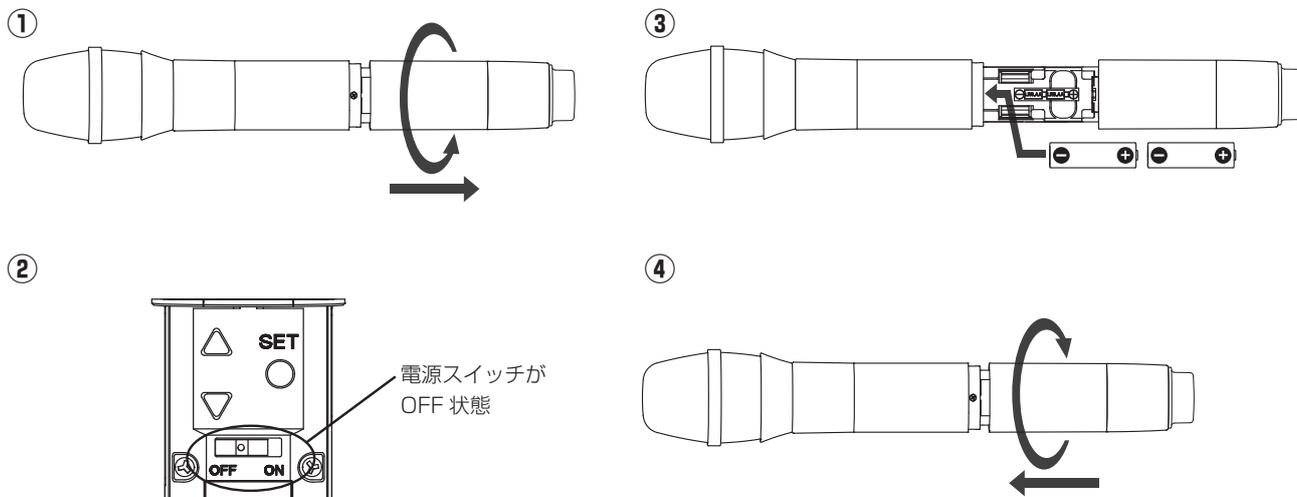
① グリップを反時計方向に回しながら、下にスライドさせます。
