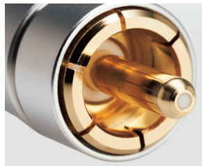
RCAプラグはピン内にグラスファイバー配合のPBT樹脂を充填。通電時のピン自体の機械的な振動を抑制させている
