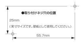
②受光ユニットのカバーをスライドさせ、木ネジをケースに通して 天井や壁などに取り付けます。
