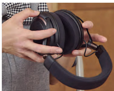
ノイズキャンセリング機能をオンにする際には、本体後部にあるボタンで操作。L側に電源とボリュームボタン、R側にはノイズキャンセリングと音漏れ抑制モードを兼ねたボタンがある
