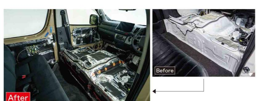
サイドウォールにもAT-AQ450+AT-AQ430を重ねて用いる。制振に加えて遮音効果を高めることでロードノイズなどの抑制に役立つ
