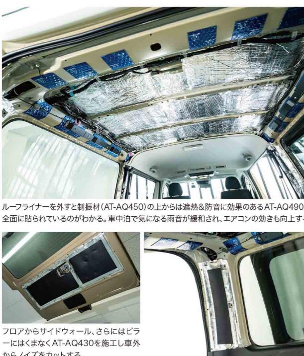
ルーフライナーを外すと制振材(AT-AQ450)の上からは遮熱&防音に効果があるAT-AQ490が全面に貼られているのがわかる。車中泊で気になる雨音が緩和され、エアコンの効きも向上する
