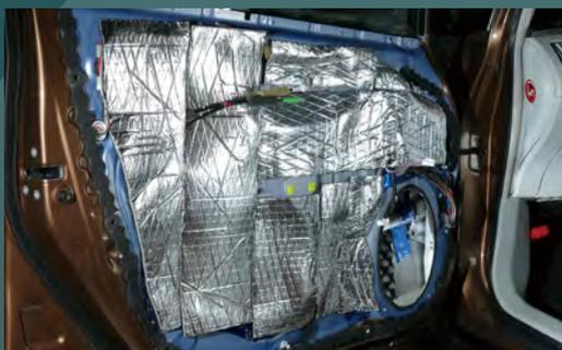
『ヒートシールドラグ』も『ノイズレスラグ』も、ドアチューニングでも使える。ドア内部に熱への対策も盛り込みたければ写真のように『ヒートシールドラグ』を併用し、外来ノイズのブロック効果を高めれば『ノイズレスラグ』を併せて使おう。
