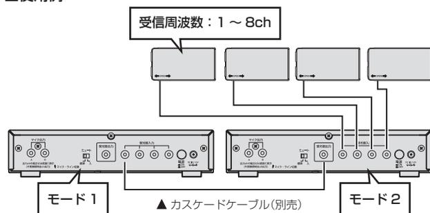
受光ユニットを5台以上使用する場合、別売のカスケードケーブルを2本使用してお互いのレシーバーを接続してください。その際、受光ユニットは両方のレシーバーに接続します。
