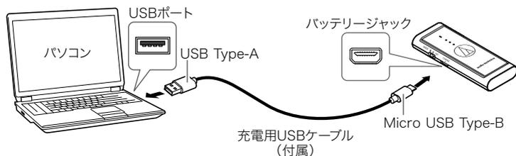
2. 付属の充電用USBケーブル(USB Type-A側)をパソコンに接続して、充電を開始します。
