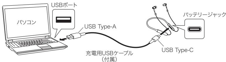
3. 付属の充電用USBケーブル(USB Type-A側)をパソコンに接続して、充電を開始します。
