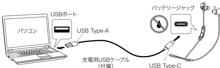
2. 付属の充電用USBケーブル(USB Type-A側)をパソコンに接続して、充電を開始します。
