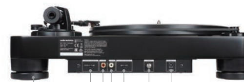
脚部 PHONO/LINE切替スイッチ ステレオ出力端子 電源入力端子 グランド(アース)端子 MM(VM)/MC型カートリッジ切替スイッチ
